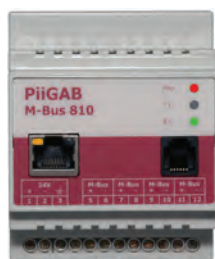
Obr. 1. Převodník PiiGAB pomůže s podivnou sběrnici M-BUS
