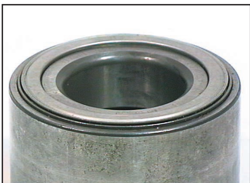
Těsnění následkem špatné montáže vyčnívá z vnitřního a vnějšího kroužku
