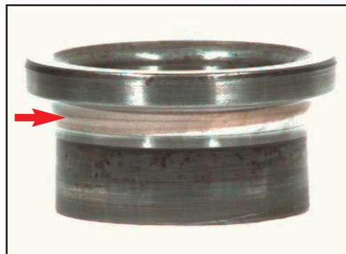
Široká barevná stopa dráhy, směřuje k osazení
