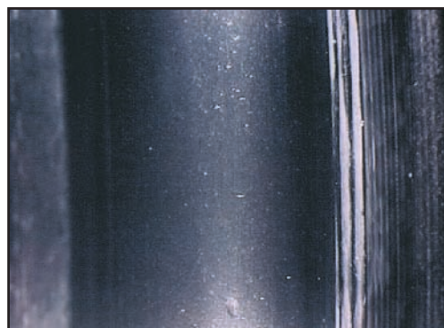
Na zvětšeném snímku oběžné dráhy je jasně patrná široká stopa dráhy valivých těles.
