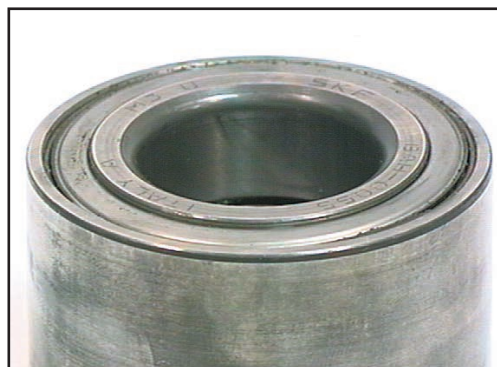
Těsnění v šikmé poloze následkem nesprávného dosednutí při montáži do kloubu.
