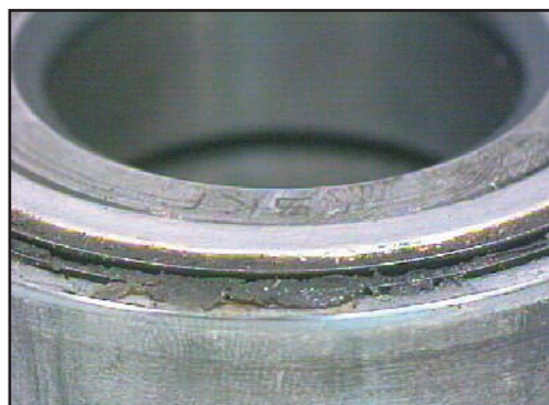
Detail obrázku vlevo zobrazuje únik plastického maziva.
