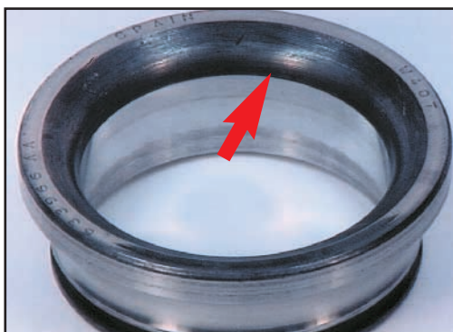
Známky otáčení na vnitřním průměru vnitřního kroužku (lesknoucí se povrch).
